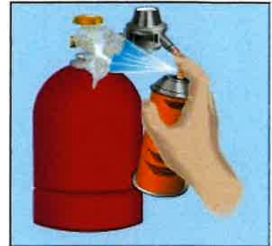
Bild 5 Dichtheitsprüfung der Anschlussverbindung
